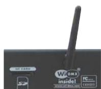
Pannello retro con lettore SD CARD per salvataggio dati e trasmettitore Wi DMX integrato.
