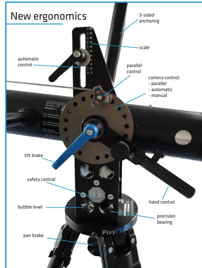
Mit nur 3.5 kg bietet das Trägerrohr des PixyPlus eine einzigartige Doppelaufnahme, um ihn als JibArm oder Kran einzusetzen. Der PixyPlus hat eine maximale Traglast von 25kg und kann problemlos von einer Person getragen und bedient werden. In der größten Ausbaustufe bietet der PixyPlus eine Länge von 11m. Die Standardversion wiegt lediglich 9 kg!
